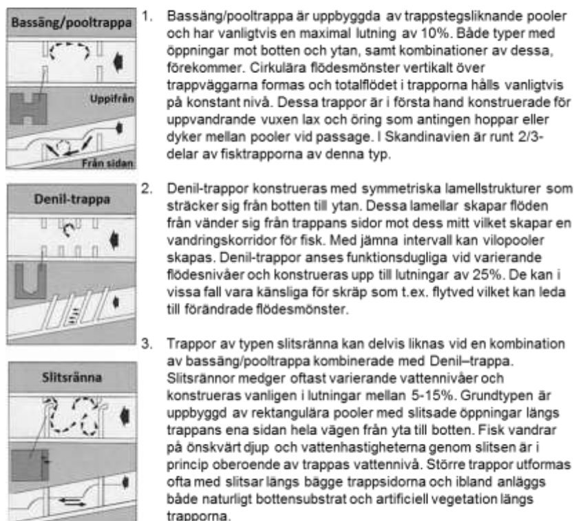
Figur 1: Tre varianter av tekniska fiskvägar med belysande text för bassäng/pooltrappa, Denil motströmstyp och slitsränna (från Rivinoja 2004).
